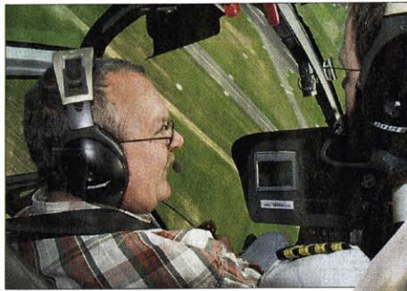
Heißer Sitz: Nach kurzer theoretischer Einweisung in die Geheimnisse eines Helikopters wird es ernst. Die linke Hand zieht den Pitch, der für das Auf und Ab verantwortlich ist und die Pedale entscheiden, ob sich das Fluggerät nach links oder rechts um die eigene Achse dreht. Und was macht die Rechte? Sie steuert mit dem Stick den Rotor und damit den Hubschrauber, und der ist, wie man weiß, das komplizierteste Fluggerät, das der Mensch je erfunden hat. Jetzt heißt es nur noch, auf den Flugschein sparen. Fotos: Florian Wagner (3), Eurocopter
